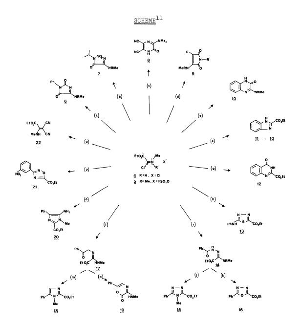
Reagents: a) PhNHCONH<sub>2</sub> b) Me<sub>2</sub>CHNHSO<sub>2</sub>NH<sub>2</sub> c) Diamiomaleonitrile d) ECH<sub>2</sub>CONHR' e) o-Phenylenediamine g) Anthranilamide h) PhNHCSNHNH<sub>2</sub> i) PhCONHNH<sub>2</sub> j) Toluene, reflux k) HCl, toluene l) PhCOCH<sub>2</sub>NH<sub>2</sub>.HCl m) p-TsOH, toluene, reflux n) Petroleum ether (bp 100-120°), reflux o) PhCH(NH<sub>2</sub>)CN p) m-Nitrobenzamidoxime q) CH<sub>2</sub>(CN)<sub>2</sub>.
